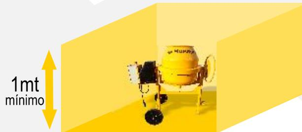
Medidas das distâncias (proteção fixa), executadas a partir dos pontos mais próximos de contato na betoneira (informações baseadas na NR12: 2010 anexo I, quadro II).
